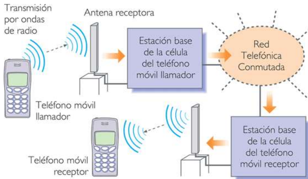
Esquema de cómo funciona la red telefónica móvil
